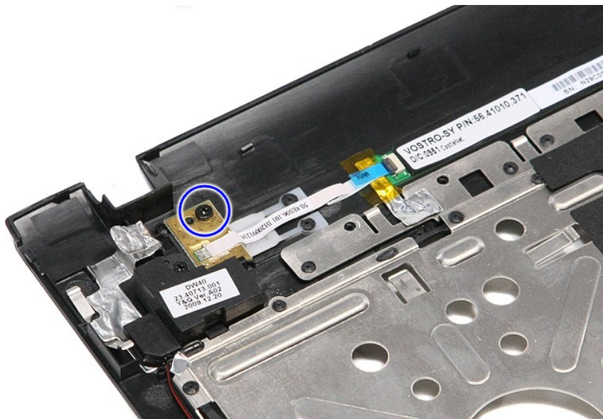
10. เปิดคลิปที่ยึดสายปุ่มเปิดเครื่องเข้ากับแผงวงจรเปิดเครื่อง
