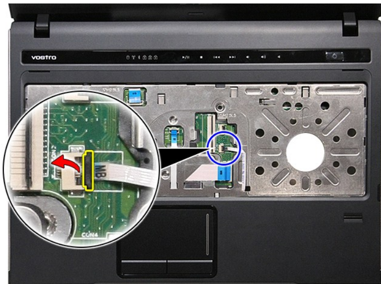
16. เปิดคลิปที่ยึดสายปุ่มมีเดียเข้ากับเมนบอร์ด
