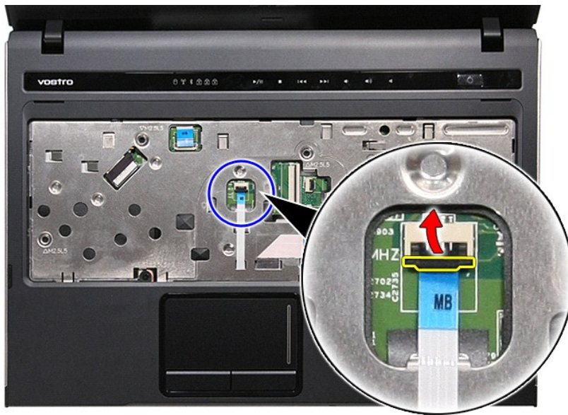
13. ปลดสายข้อมูลทิ้งแพดจากข้อต่อที่เมนบอร์ด
